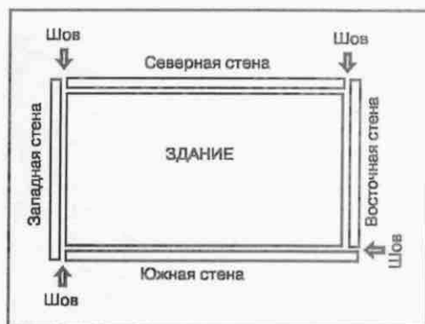
Распределение швов по углам здания
